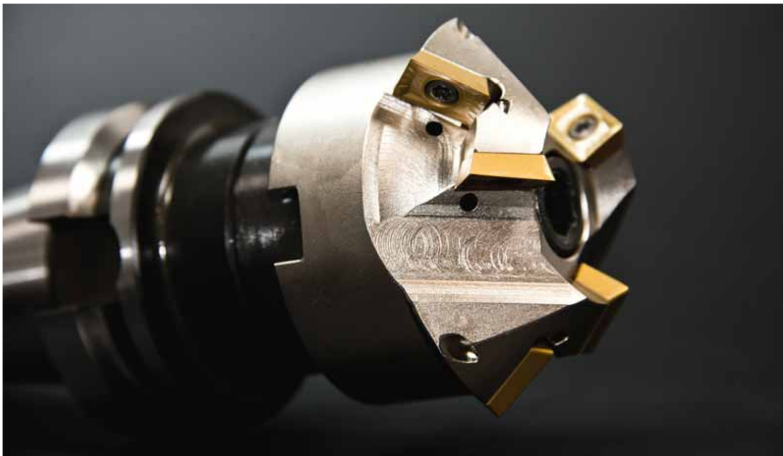
Slijtage kan fors worden verminderd door het aanbrengen van een coating.
